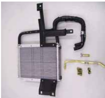
Sebuah Perdana V6 yang telah dipasang dengan 'Automatic Transmission Oil Cooler'.
