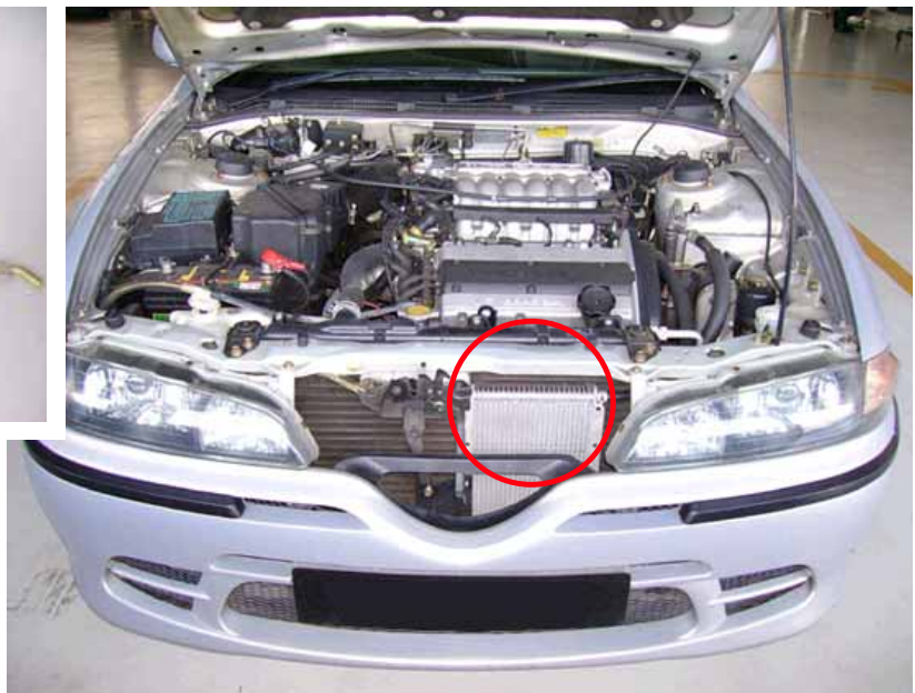
Sebuah Perdana V6 yang telah dipasang dengan 'Automatic Transmission Oil Cooler'.
